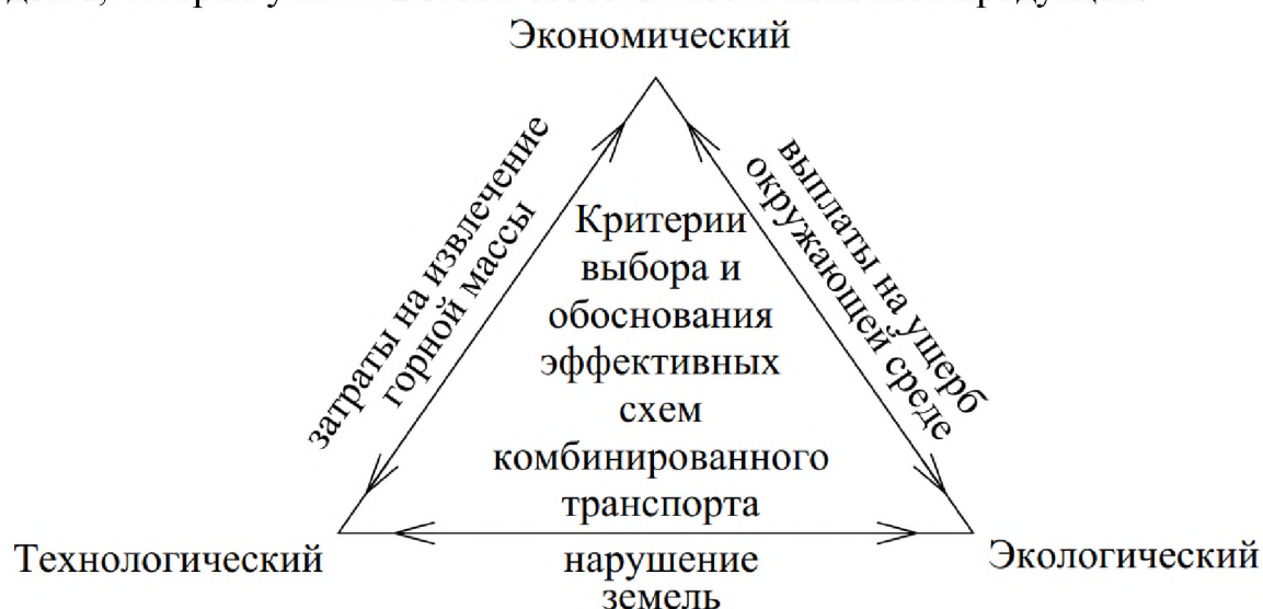
Рисунок 2.1 Связь условий выбора схем внутрикарьерного транспорта на глубоких карьерах
